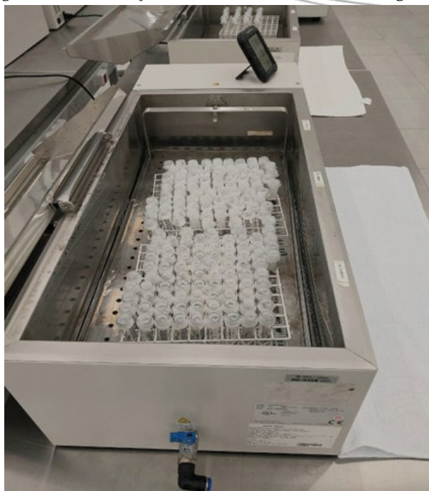
Figura 7 – Incubação das amostras na fase de digestão.
