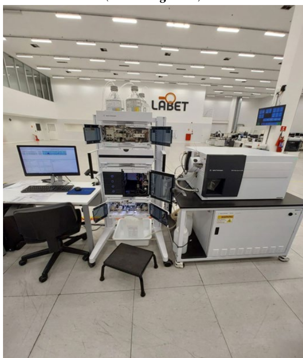
Figura 11 - Sistema LC-MS com cromatógrafo, espectrômetro e interface computadorizada (cromatograma).
