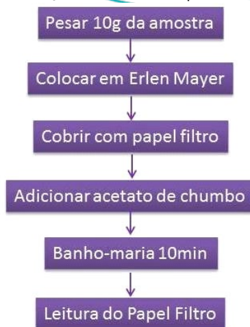
Imagem 2 - Histograma do Teste para Gás Sulfídrico.
