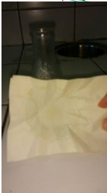
Imagem 6 - Resultado do Teste de Éber para gás sulfídrico da Temakeria 6.
